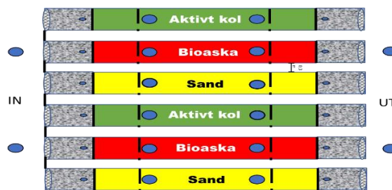
Bild 1. Design av pilotanläggning för aktiv rening av förorenat grundvatten (blå cirklar indikerar provtagningspunkter).
