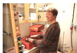
Bild 1. En av kulkvarnarna som användes i labbförsöken för den mekanokemiska behandlingen.
