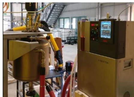
Bild 1. Den utrustning för hydrotermisk karbonisering (HTC) som köpts in inom delprojektet. Reaktorkärl är på 20 liter, med oljeburet värmesystem.
